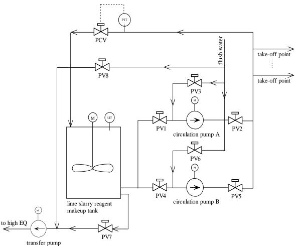
Figure 2.10.5 Lime Slurry Circulation System
